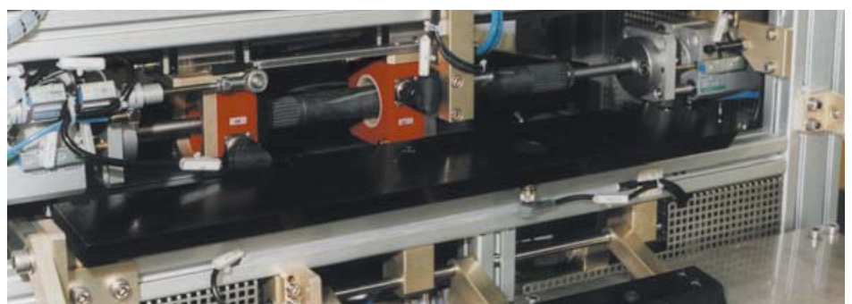
Die Prüfspulen verfahren zu den vier Prüfpositionen (siehe Pfeilmarkierung) der Welle.
