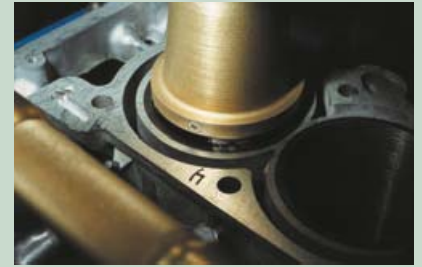
Prüfsystem zur Rissprüfung an Motorblöcken.
