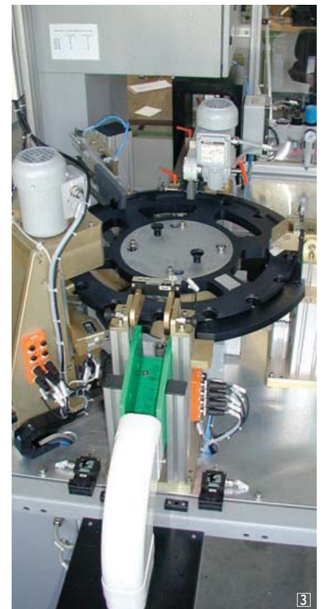
Photo 2: Installation typique avec stations de contrôle de détection de fissures et de contrôle de structure. Le passage automatique d'une pièce étalon (optionnel) garantit une qualité de contrôle constante.
