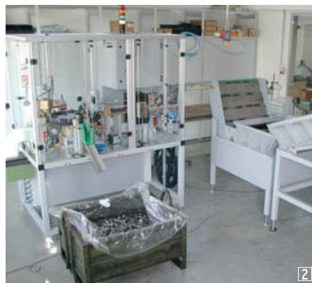
Photo 2: Installation typique avec stations de contrôle de détection de fissures et de contrôle de structure. Le passage automatique d'une pièce étalon (optionnel) garantit une qualité de contrôle constante.
